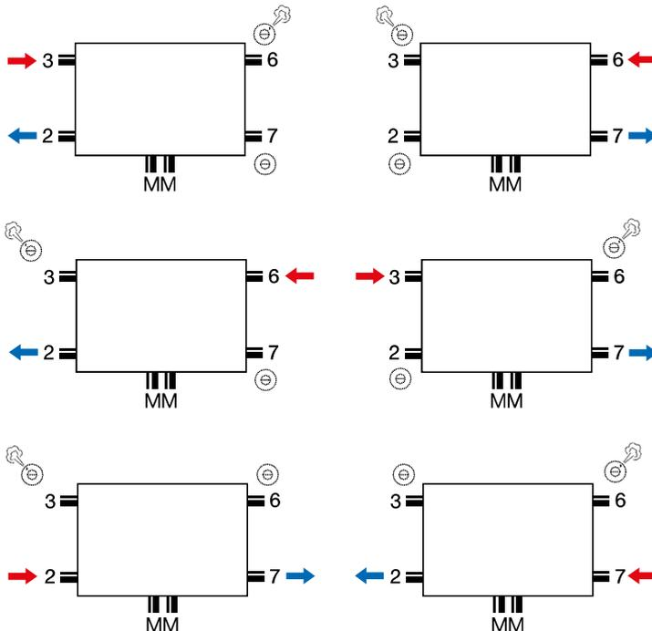
**Raccordement de la vanne à gauche :**
